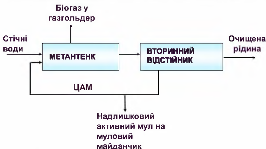
Рисунок 6.4 – Схема анаеробного очищення стоків
